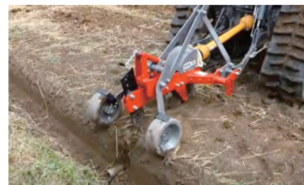
写真2=サブソイラによる弾丸暗渠の施工
